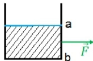
La pression que l'on note  $P$  est le quotient de l'intensité de la force  $\vec{F}$  par l'aire de la surface pressée  $S$ . L'unité de pression est le pascal (Pa).
